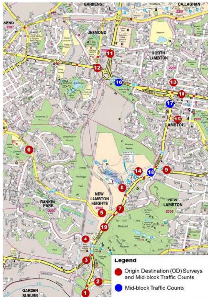
1.5. att. Pirmais piemērs: apsekojumu krustojumu un punktu izvietojums
