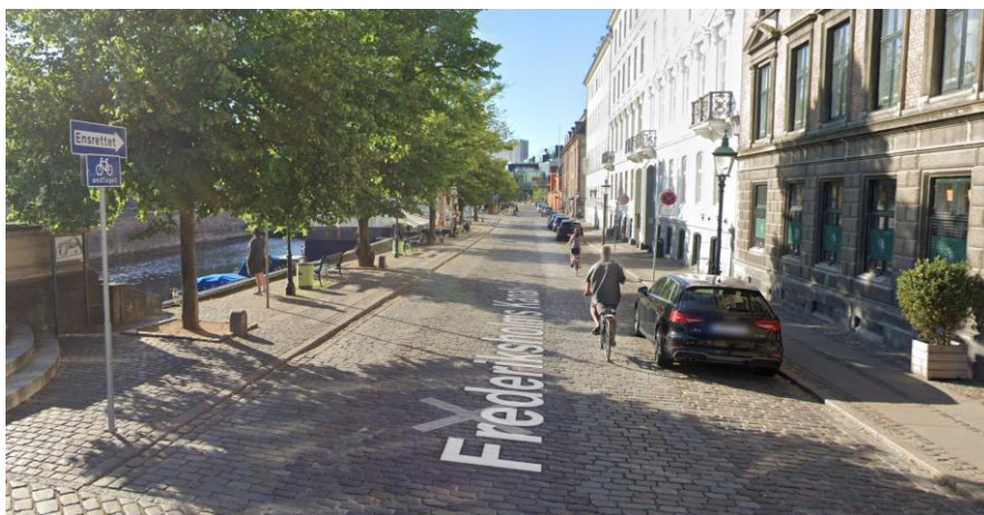
2.2.1.13.attēls. Rekomendejošā velojoslas, izmantojot akmens bruģa joslas Kopenhagēnā (Frederiksholms Kanal) 119
