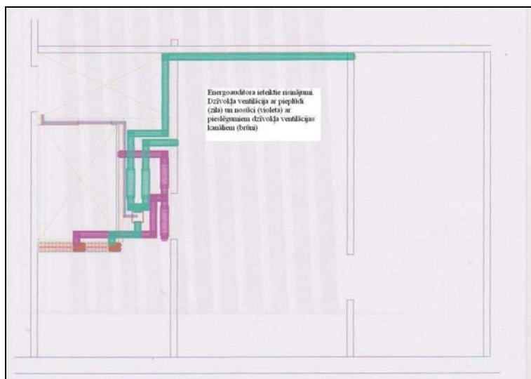
Energoauditora ieteiktie risinājumi. Dzīvokļa ventilācija ar pieplūdi (zila) un nosūci (violeto) ar pieslēgumiem esošajiem dzīvokļa ventilācijas kanāliem (brūni)
