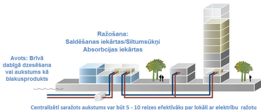
Attēls Nr. 1: Centralizētās aukstumapgādes pamatprincips [1]
