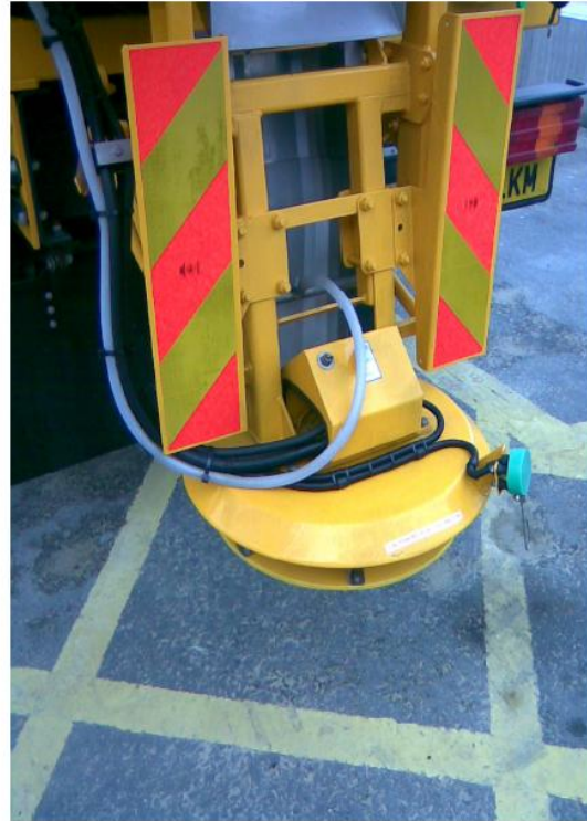
8.1.attēls. Diskveida izsmidzināšanas iekārta virsmas apstrādei ar CMA (labajā pusē); kreisajā pusē redzama automašīna, kas aprīkota ar CMA šķīduma tvertnēm
