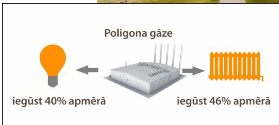
9.15. attēls. Avots: SIA „Getliņi EKO”. Biogāzes koģenerācijas stacija
